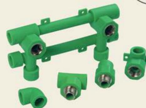
Los accesorios están fabricados de acuerdo con DIN 16962 de Polipropileno Aleatorio (Tipo 3) y están disponibles en diámetros desde 20 mm hasta 450mm. Para la producción de los accesorios, la empresa utiliza materia prima con un índice de flujo de fusión bajo, idéntico al de sus tuberías, de modo que la resistencia mecánica de la tubería no difiera de la de los accesorios. Se producen con un espesor de pared equivalente a 30 bares.
