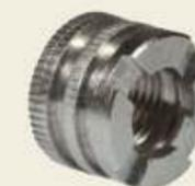
Las piezas de latón (inserciones metálicas) son reforzadas, de tipo resistente, y de baja dureza (105 Brinell), eliminando así la posibilidad de agrietamiento, que es particularmente común en accesorios con rosca hembra. Tienen ranuras en forma de cruz en la base del inserto de latón para evitar la torsión y el consiguiente desprendimiento del metal de la parte plástica.
