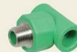
El PP-R se superpone a los insertos de latón macho en el interior. De esta manera, las partes metálicas se aíslan de la instalación, y se evitan los depósitos sólidos y, en consecuencia, el flujo reducido. Además, el sistema está protegido contra la corrosión electroquímica.
