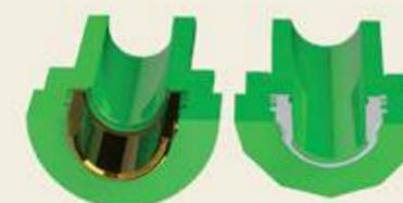
Ranuras de retención perimétricas, en las que un lado de la ranura tiene declinación negativa, desde el exterior hacia adentro, para retener el material PP-R y evitar el desprendimiento de la parte metálica de la parte plástica en presencia de fuerzas de tracción.
